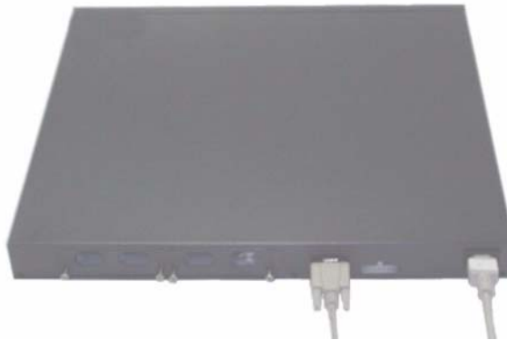
Figura 1-4. Conexión al puerto de la consola
