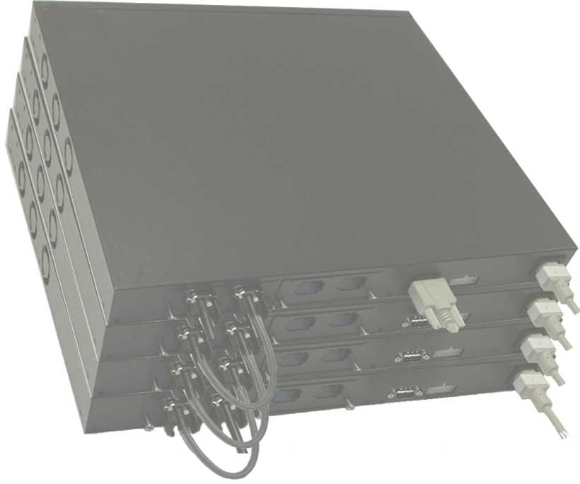
Şekil 1-3. Bir Anahtar Kümesinin Balanması
