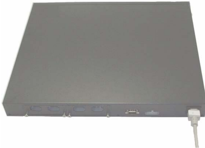
Figura 1-2. Conexión del cable de alimentación
