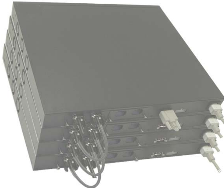
Rysunek 1-3. Łączenie wieży przełączników
